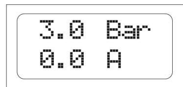
**Главный экран:** когда *Brio Top* работает normally, на дисплее показано состояние устройства. В верхней строке указывается давление, измеренное в установке, а в нижней строке указывается ток, поглощенный двигателем. На этом экране можно держать нажатой кнопку “+” для того, чтобы насос работал форсировано, даже без наличия воды, чтобы исключить защиту от «сухого» хода и позволить залить водой сам насос.
