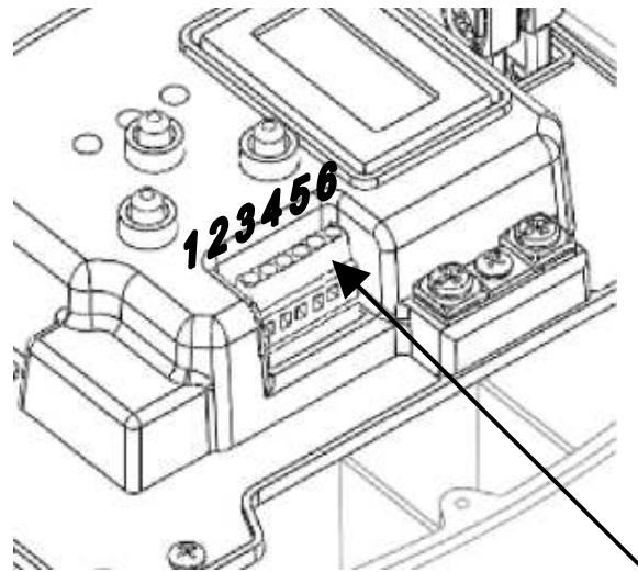
*Brio Top* оснащен соединителем, при помощи которого становятся доступны вспомогательные контакты для использования дополнительных функций, соединяя устройство с другими внешними аппаратами.
