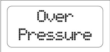
**Слишком высокое давление:** срабатывание данной тревоги указывает, что *Brio Top* обнаружил давление в установке свыше величины, отрегулированной в параметре “Plimite”. Это может случиться в системах с насосами на загрузке, то есть когда давление насоса суммируется с давлением нагрузки на входе. Если данная ошибка часто возникает, то следует попробовать увеличить параметр Plimite или обратиться к монтажнику. Для устранения состояния ошибки, нажать на центральную кнопку “reset” (сброс).
