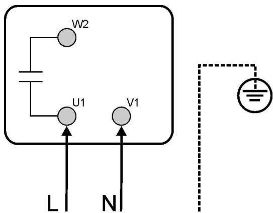
*Brio Top* может монтироваться на однофазные насосы с питанием 230 В переменного тока, уже оборудованные конденсатором.
